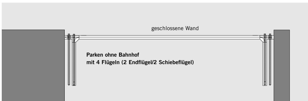
Gerade Laufschiene mit Parkposition quer zur Laufrichtung
