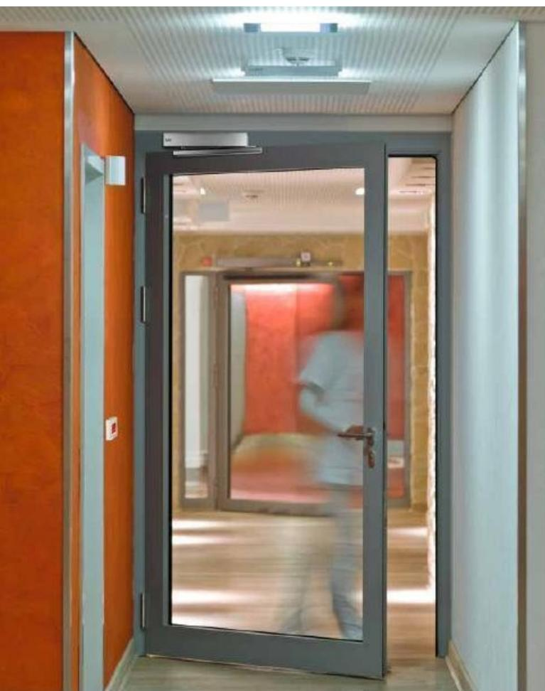
Volnoběžný dveřní zavírač DORMA TL 99 zajišťuje volné otevření dveří bez jakéhokoli odporu.
