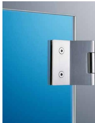
**Edelstahl-Band für Rahmenteile**, mit Edelstahl-Hülse, Edelstahl-Bolzen, Flügelgewicht max. 55 kg. Für 8 mm Glasdicke bei 24 mm Falztiefe bzw. 10 mm Glasdicke bei 26 mm Falztiefe, Flügelbreite max. 1.000 mm. Bänder entsprechen der höchsten Korrosionsschutzbeständigkeitsklasse (EN 1670, Klasse 4). Auf Anfrage auch als Version mit abgerundeten Ecken erhältlich.
