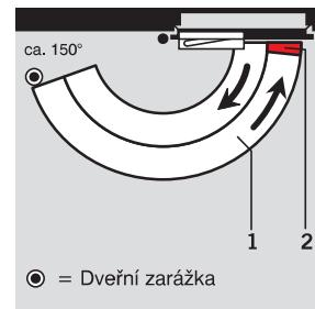
1 Plynule nastavitelná rychlosť zavírání v rozsahu 150° – 0°
