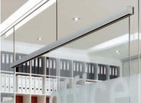
Ein echtes Highlight ist die ins Trennwandsystem integrierte Schiebetür. Die obere Laufschiene wird direkt ins Glas eingepasst, durch die Hängemechnik bleibt der Fußboden im Durchgangsbereich schwellenfrei. Siehe auch Technische Info Seite 89.
