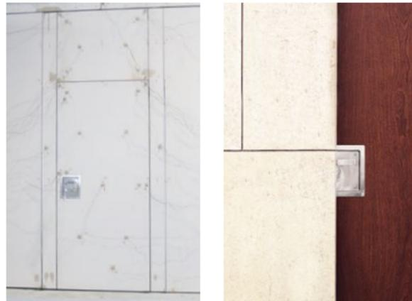
Um die Feuerwiderstandsklasse zu ermitteln, wurde in einem Prüflabor eine Wandseite der Variflex EI 30 mit integrierter Durchgangstür länger als eine halbe Stunde direktem Feuer ausgesetzt.
